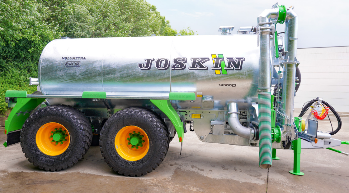
Направляющая ось и гидравлическая подвеска Hydro-Tandem
